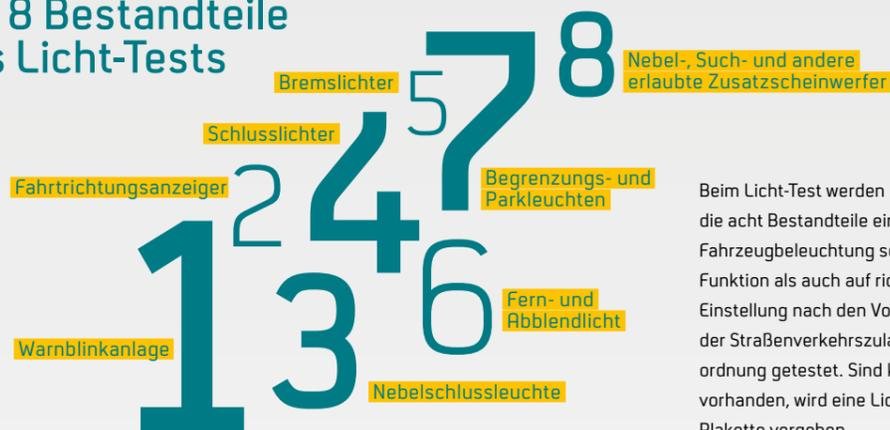
Beim Licht-Test werden die acht Bestandteile einer Fahrzeugbeleuchtung sowohl auf Funktion als auch auf richtige Einstellung nach den Vorgaben der Straßenverkehrszulassungsordnung getestet. Sind keine Mängel vorhanden, wird eine Licht-Test-Plakette vergeben.
